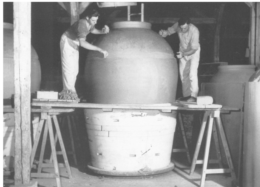
Herstellung einer 2000 Liter Speicherflasche (Probst, H.: 130 Jahre Firmengeschichte, Von der Steinzeug zur FRIATEC, Mannheim 1993; S. 279)
